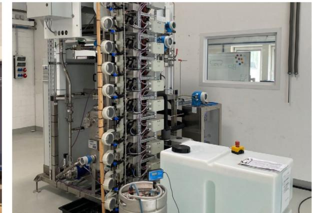
Teststand für 10 AEM-Stacks
