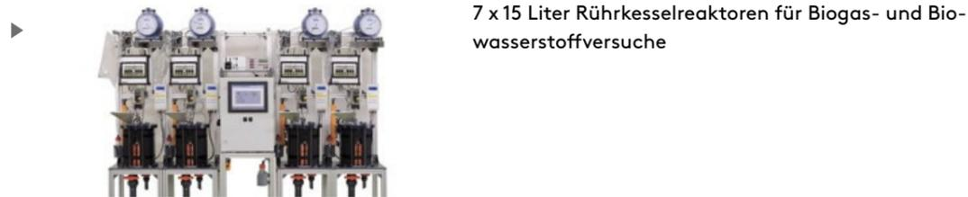
7 x 15 Liter Rührkesselreaktoren für Biogas- und Bio-wasserstoffversuche
