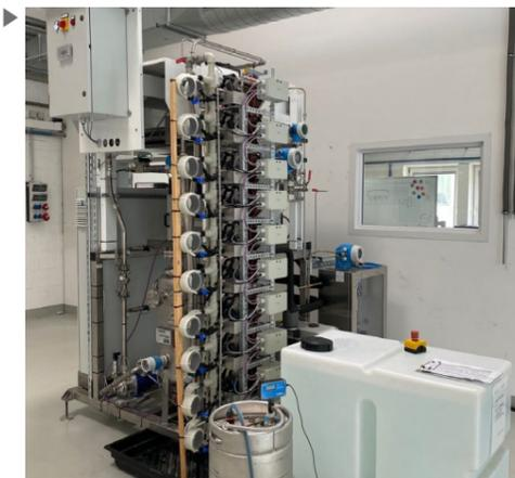
Der Teststand besteht aus zehn hydraulisch und elektrisch verschalteten AEM-Elektrolyseestacks der Firma Enapter. Zu den Subsystemen gehören u. a. ein beheizbarer Tank für das Elektrolyt, einer Pumpe und ein Tischkühler sowie die Leistungselektronik.
