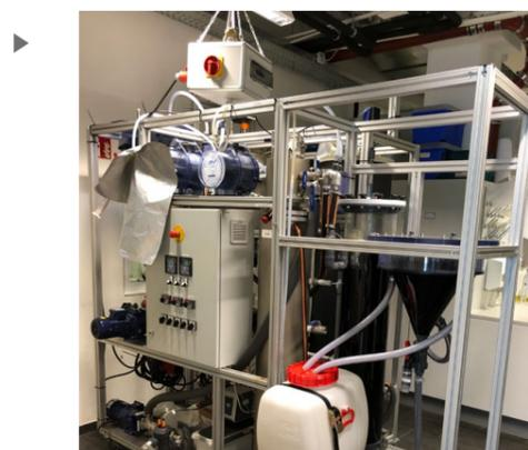
1 x 175 Liter, dreistufige Abwasserbehandlungsanlage mit anaeroben Belebungsverfahren (CSTR, Sedimentationsbecken), Hochlastreaktor (EGSB) und aeroben Belebungsverfahren (Belüfteter Reaktor, Sedimentationsbecken)
